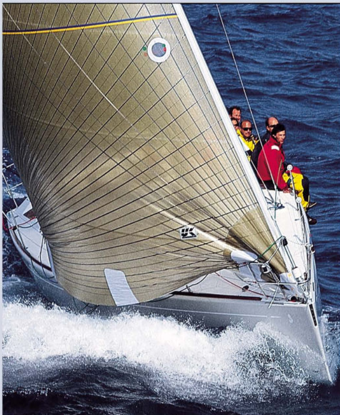
GORE: Laminirani materijal napravljen od Kevlara sa trakama od Carbona DESNO: One Design jedrilica sa laminiranim materijalom od polyestera i polyesterskim trakama
